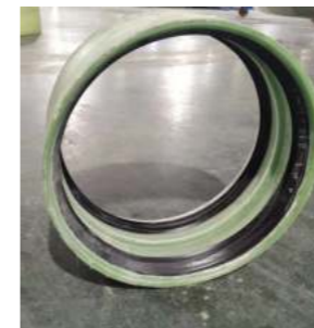
一体式橡胶密封圈套筒接头
